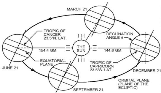
半径70万km絶対温度6,000° kの太陽から1.5億km離れた地球の軌道上、宇宙で受けるエネルギーは1324W/m<sup>2</sup>h（太陽定数）、これに大気での遮り（airmass）を考慮して算出されている。ASHRAEの基礎編ハンドブック14章に詳しく掲載されており、この手法を用いて日本各地の日射データを計算できるexcelシートを中部支部サイト
